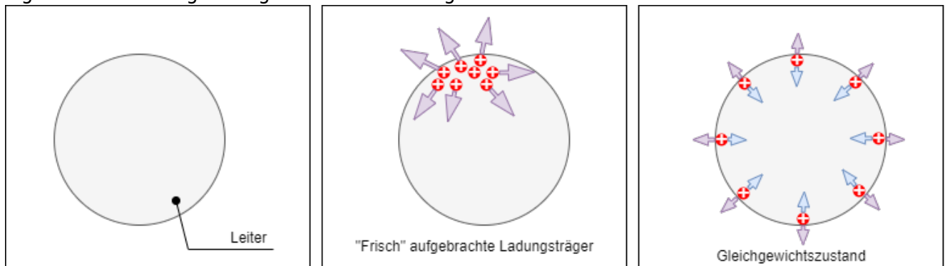
Fig. 13: Betrachtung einer geladenen Metallkugel
