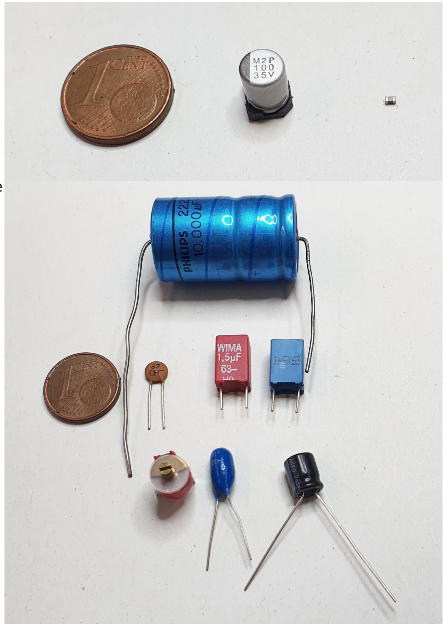
Fig. 18: Bauformen von Kondensatoren
