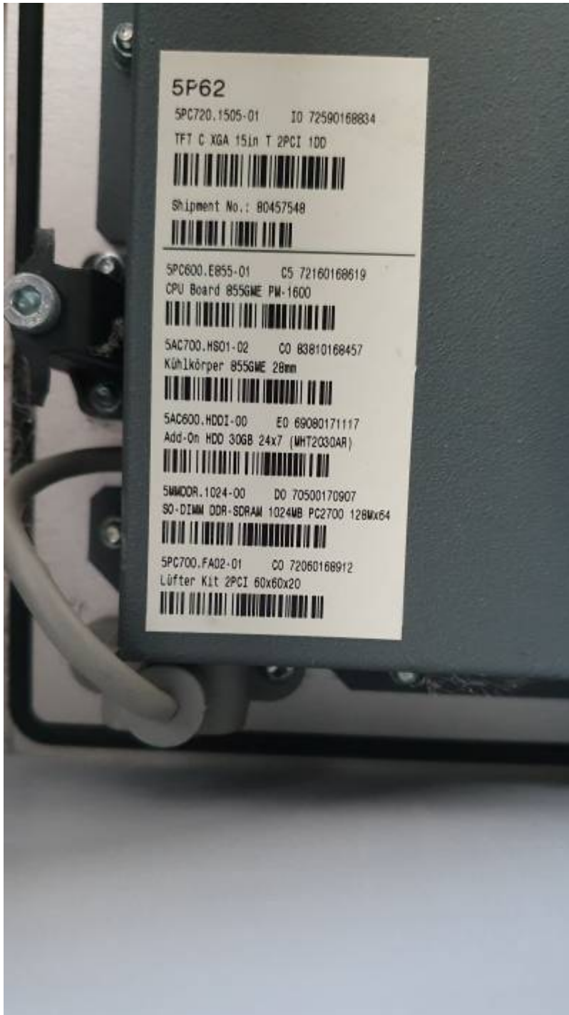
PANEL PC 5PC720 - Displayrückseite
