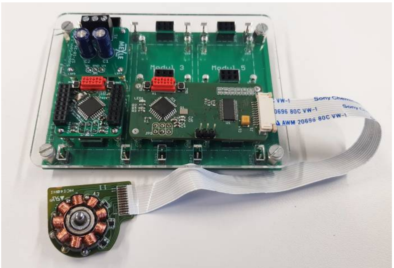
Beispielaufbau mit Stromversorgung (links oben), Microcontrollerplatine (links unten), Motortreiberplatine (rechts)
